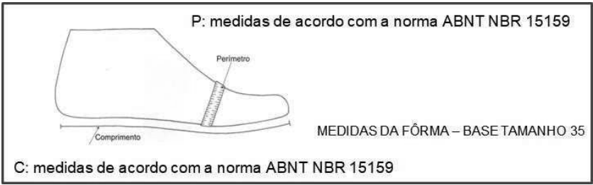
Figura 3 – Medidas da Fôrma
