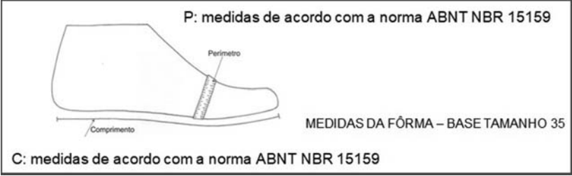
Figura 3 – Medidas da Fôrma
